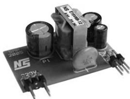
Модуль питания предназначен для питания постоянным стабилизированным напряжением различных устройств. Конструктивно модуль выполняется в виде запаянной печатной платы без корпуса. Входное переменное напряжение и выходное постоянное напряжение коммутируется штыревыми выводами PLDR, расположенные снизу модуля. Так же посредством этих выводов модуль запаивается в основную плату.
